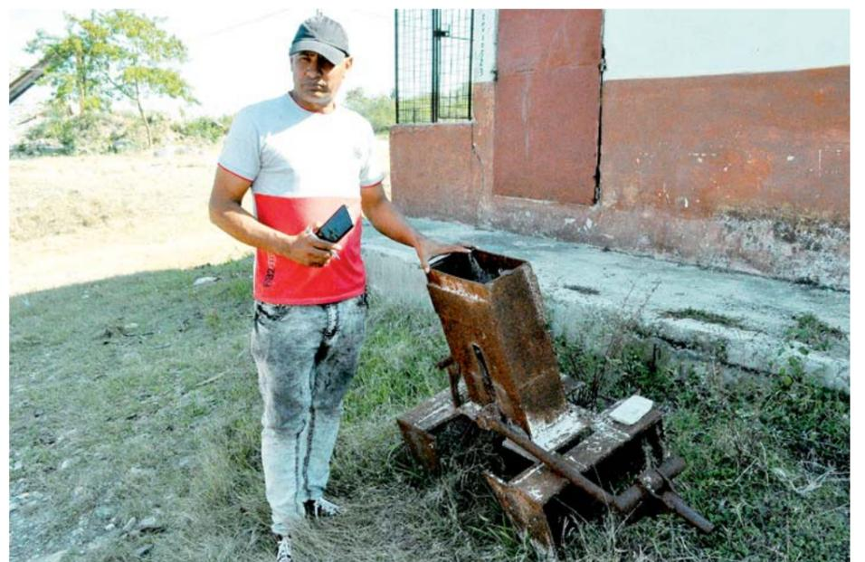
Braudilio Gamboa explica que laboran en la recuperación de máquinas para bloques machihembrados
